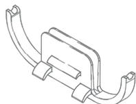
Adattatore per profili a paletta alle ampiezze degli scaffali a C fino ad un max 30 mm.
